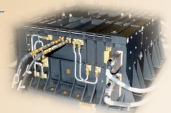
A bord des satellites, l'encombrement des récepteurs diminue. Dotés initialement d'un seul canal, les récepteurs de la dernière génération (DGXX) en comportent sept et peuvent ainsi recevoir simultanément les signaux de sept stations différentes.
