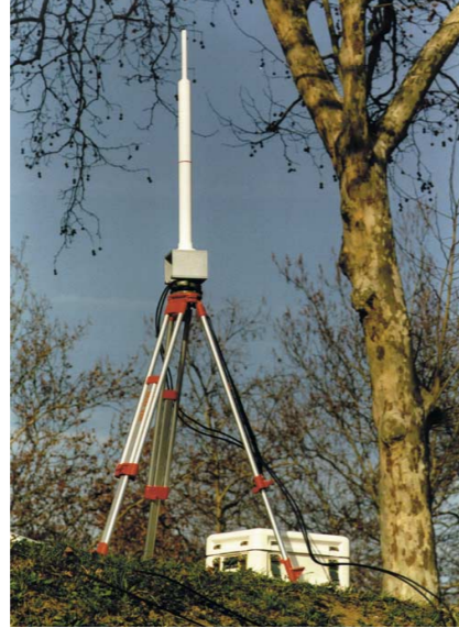
Les antennes et stations DORIS sont très facilement transportables pour faciliter des opérations de localisation précise temporaires.
