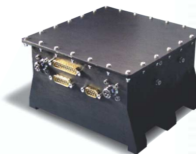
Le GPS, qui réceptionnera en permanence les signaux issus de 12 satellites GPS, complètera le système DORIS pour connaître la trajectoire du satellite avec une précision centimétrique.
