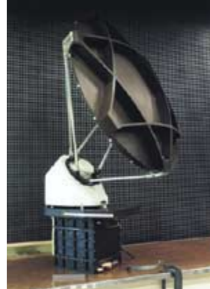
Le radiomètre, ici avec son antenne, permettra de mesurer très précisément le contenu en vapeur d'eau de la troposphère et de corriger en conséquence les mesures radar altimètre.
