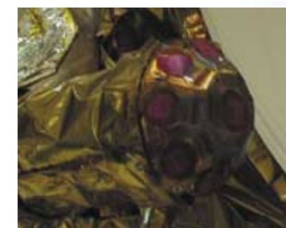
Le réflecteur laser placé sur le satellite Jason, sera utilisé pour faire des mesures complémentaires d'orbitographie à partir de stations laser sol.
