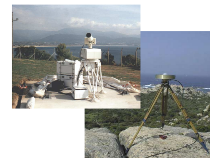
Le CNES a mis en œuvre, avec l'appui du CERGA et de l'IGN, le site de Senetosa en Corse pour vérifier et étalonner les mesures altimétriques Jason-1. La station laser ultramobile développée par l'OCA, le CNES, l'IGN et l'INSU appuiera ces opérations.
