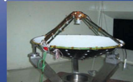
Antenne altimètre (Alcatel) - Modèle de vol avant essais de qualification mécanique et thermique.
