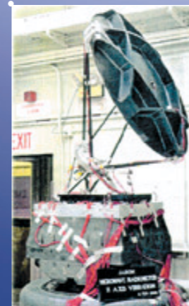
Radiomètre (NASA/JPL) - Modèle d'ingénierie avant essai de qualification mécanique.
