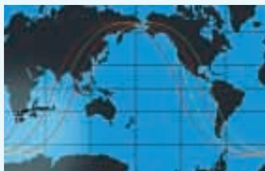
Figure 1. Les orbites de Topex/Poséidon et Jason-1 sont similaires, décalées de 158 km |
